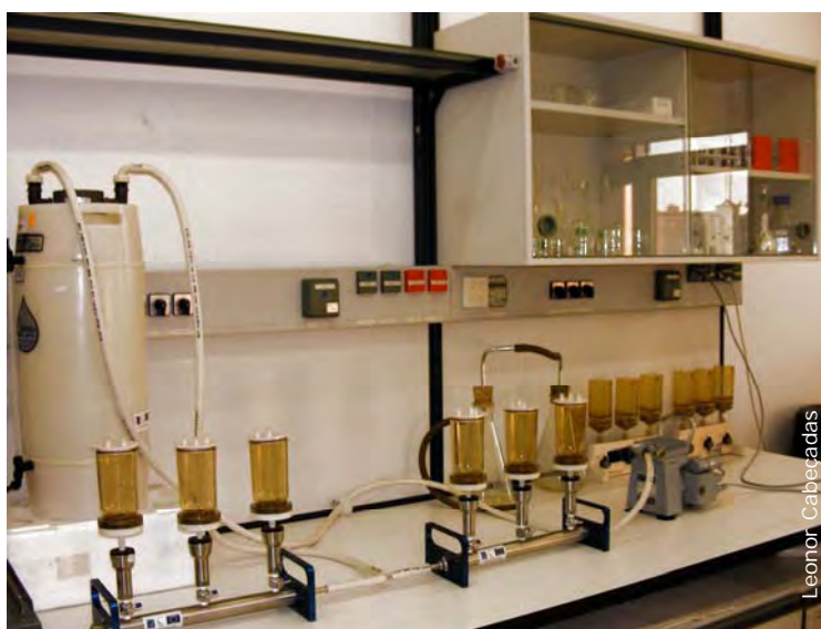
Figura 8 - Rampa de filtração.
